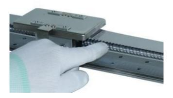
c) 滑軌添加潤滑油方式(直接塗抹)。
