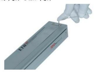
c)移除防塵鋼帶與鋼帶壓板。
