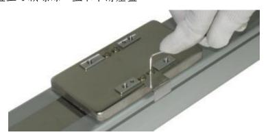
b)移除固定防塵鋼帶的 4 顆螺絲, 2 顆於反馬達側、2 顆於馬達側。
