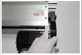
10 再套入馬達鎖附之皮帶輪,需注意皮帶位 置須保持在皮帶輪置中部位。
