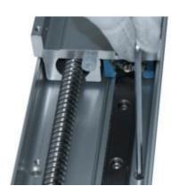
e) 安裝側蓋或上蓋回本體。 ECH5M ECH6M機型需先拆下防塵鋼帶以避免鋼帶受損。 (拆卸方式請參考 5-3 更換或調整防塵鋼帶。)
