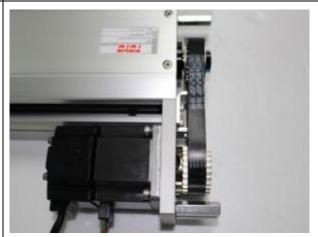
11 用開口扳手調整外六角螺絲,以調緊馬達 環帶鬆緊度。
